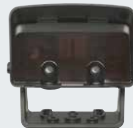
Ραντάρ ανίχνευσης κίνησης MWD C γρήγορο και στοχευμένο αυτόματο άνοιγμα πόρτας, με αναγνώριση κατεύθυνσης, μέγ. ύψος τοποθέτησης 7 m, τοποθέτηση σε περιοχή κατάψυξης μέχρι μέγ. -22 °C, IP 65
