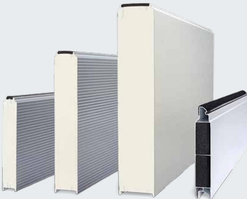
Θερμικά διαχωρισμένα χαλύβδινα πάνελ σάντουιτς σε τρία πάχη: 42, 67 και 100 mm, ακουστικό πάνελ
